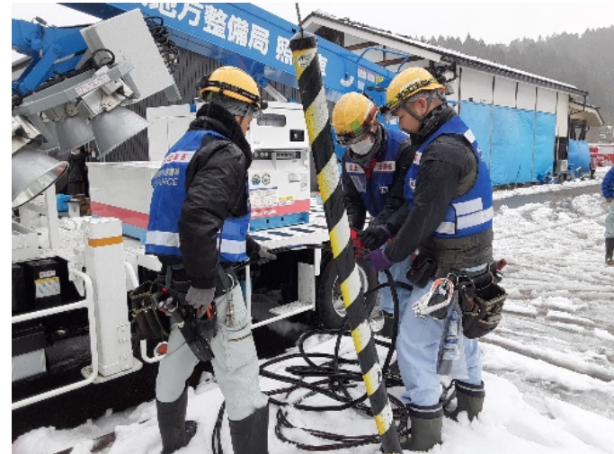
電源支援班による避難施設への照明車による電源供給
