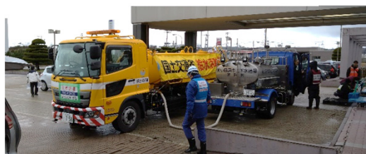
給水機能付散水車(給水支援)
