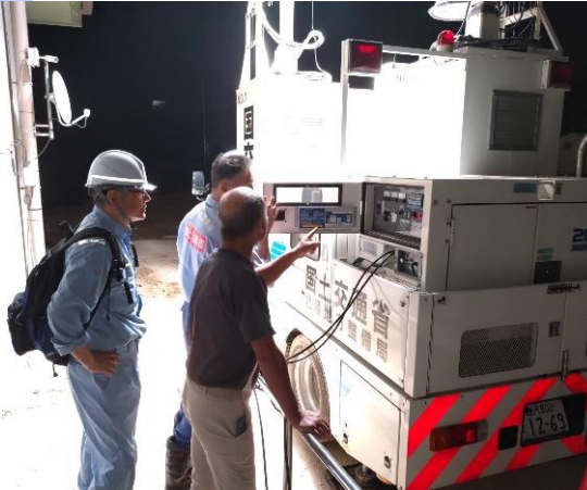
照明車による電源供給作業状況 (珠洲市 大谷小中学校)
